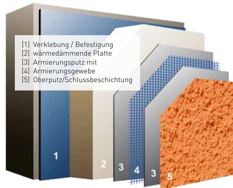
gestimmt sind. Bei klebegeeigneten Untergründen dürfen bestimmte Dämmplatten auch ausschließlich durch Verkleben befestigt werden. Einige Wärmedämm-Verbundsysteme werden mit einer geeigneten Unterkonstruktion (Schienensystem) an der Wand befestigt.
